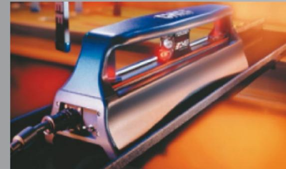
il sistema dimostrerà che il telaio del veicolo è fuori allineamento, di quanto e in che direzione; Inoltre, lasciando lo scanner in posizione durante la riparazione si ha la misurazione in tempo reale del veicolo durante le fasi di tiro.
